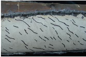
图4 管内混凝土的裂缝分布
