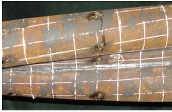
图3 试验构件的扭转变形
