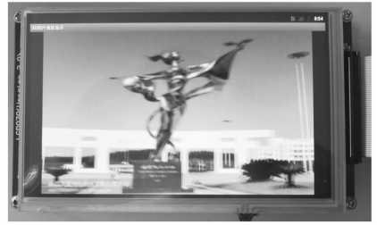
图 6 17.78 cm(7.0 in)液晶屏分辨率为 800 \times 480
