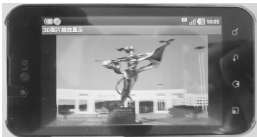
图 5 8.89 cm(3.5 in)液晶屏分辨率为 480 \times 320
