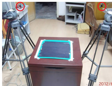
图 2 真三维两点触控系统结构
