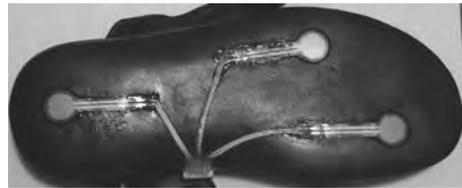
图 2 安装薄膜压力传感器的压力鞋
