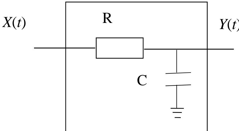
$$H(\omega) = \frac{a}{a + j\omega} \quad \text{其中} \quad a = \frac{1}{RC}$$
