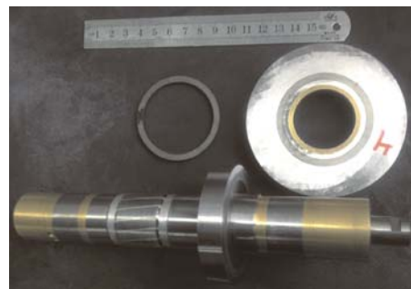
图 7 轴向 PMB 照片 Fig. 7 Photo of the axial PMB
