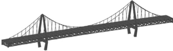
图 3 永宗大桥计算模型
