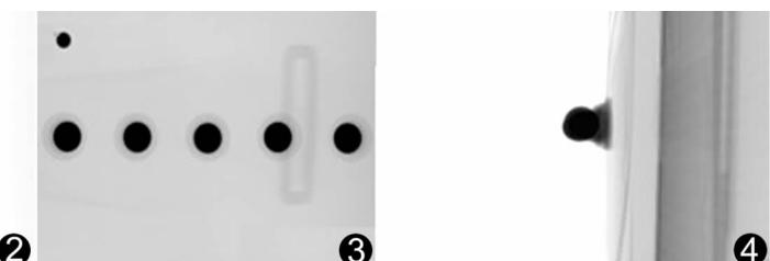
图 1 RAO 100°(-100°) 时钢球影像 5 个钢球部分重叠,最大钢球影像为左边缘区钢球
