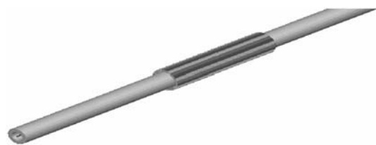
图 2 直极片 ECT 传感器示意图
