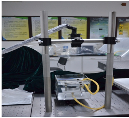
图5 激光头垂直放置示意图
