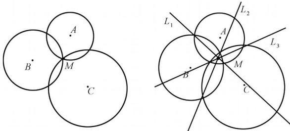
图 1 三边测量法图示      图 2 三边测量实际情形
