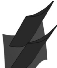
图 8 第一列静子叶片三维造型
