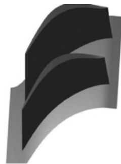
图 9 第二列转子叶片三维造型
