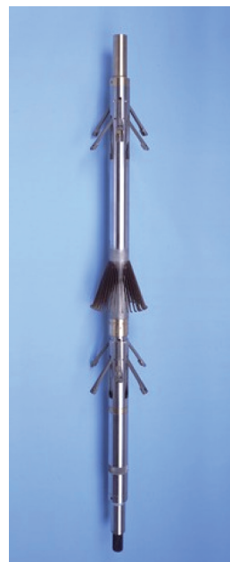
图 7 贝克休斯公司 ICL 成像井径仪 Fig. 7 ICL imaging caliper log instrument
