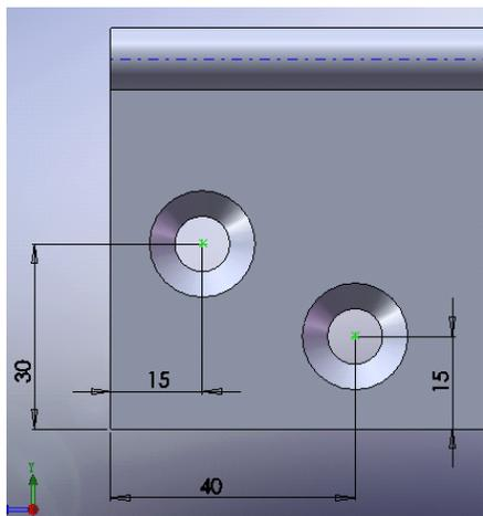
使用异型孔向导在指定的面上添加M8的平头螺钉孔两个，并标注尺寸。
