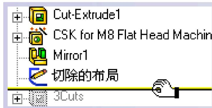
拖动退回控制棒至切除布局草图的下面，使设计退回到三处切除特征。
