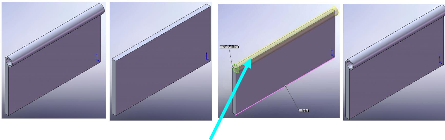
**TIP:** 使用扫描生成铰链头，扫描的路径为叶片的长边。
