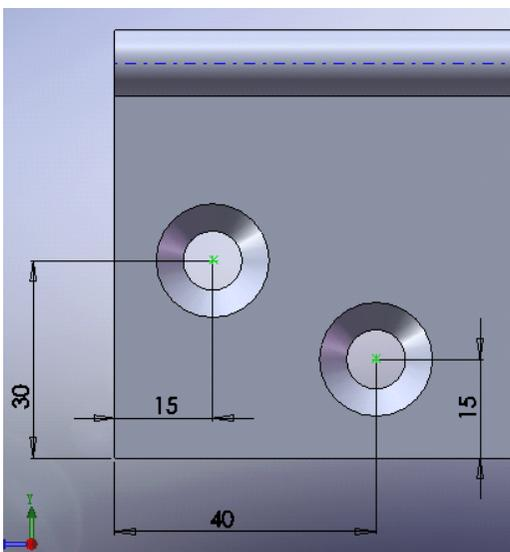
用方程式建立两个孔的定位尺寸于叶片长度与宽度尺寸之间的数学关系。
