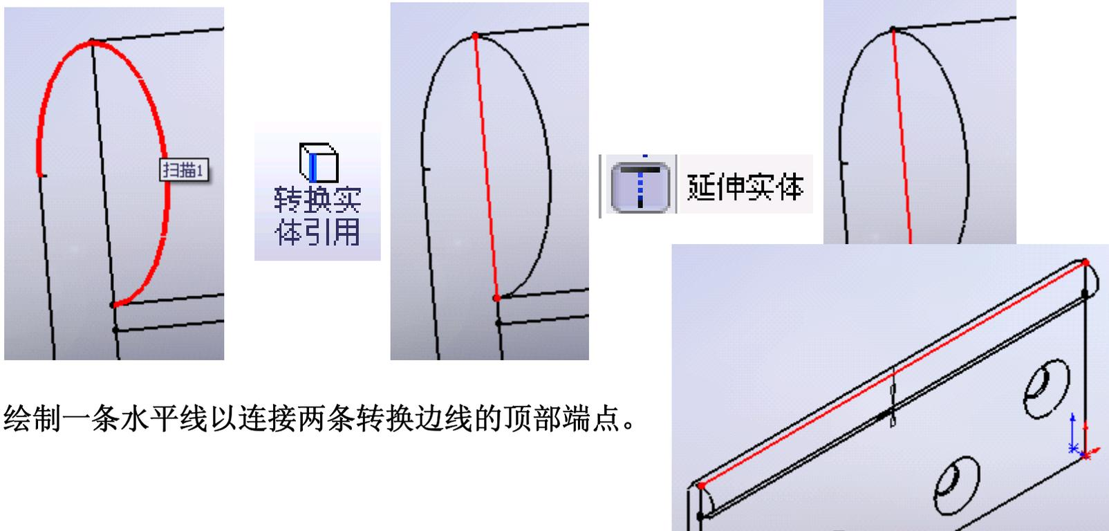
绘制一条水平线以连接两条转换边线的顶部端点。
