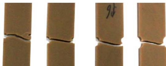
图5 切口试件断裂的宏观形貌
