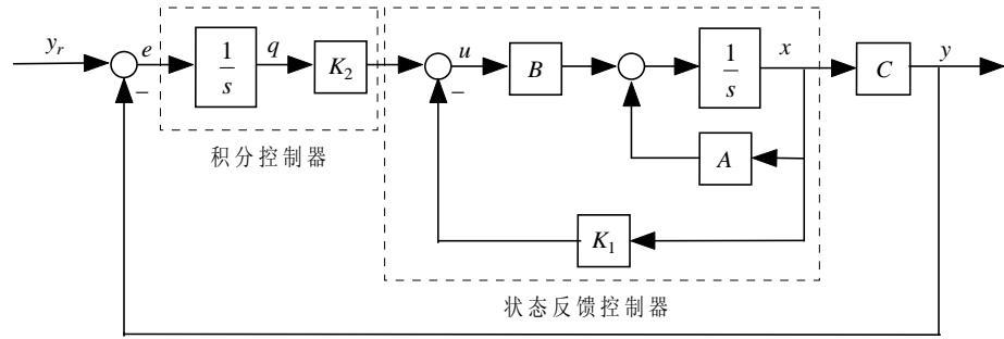
构建增广系统，通过极点配置方法来设计增广系统的状态反馈控制器，从而使得闭环系统不仅保持期望的动态性能，而且避免了稳态误差的出现。
