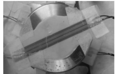
图 3 锰铜压阻传感器
