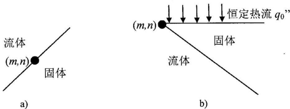
b) 端部节点  $(m, n)$ , 上边具有恒定热流  $q_0''$ , 流体温度为  $T_\infty$ , 换热系数为  $h$ , 固体导热系数为  $k$ , 假定  $x$  和  $y$  方向上的空间步长相等。
