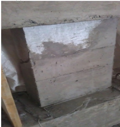
(c) ECC 浇筑后的试件正面图
