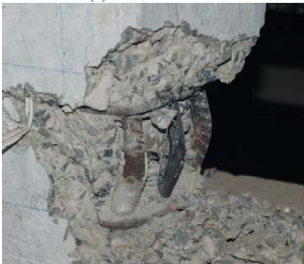
(b) 试件BZ2钢筋屈曲
