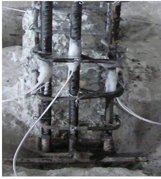
(b) 钢筋应变片粘贴示意图
