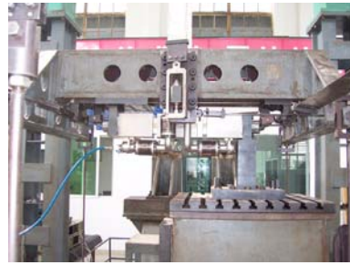
图5 空气桥与天平组合校准
