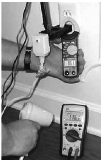
图7 理论上测量线路电压降的方法
