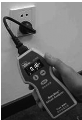
图8 交流电路分析仪测量线路电压降
