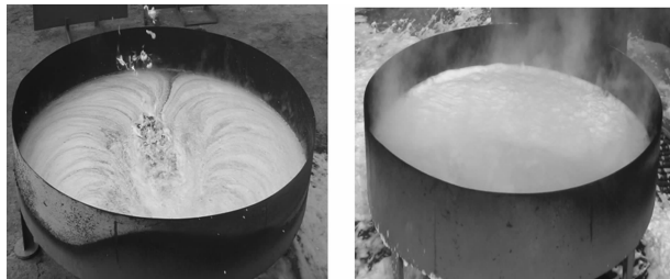
图 1 压缩空气泡沫系统与负压式泡沫系统所喷射泡沫的比较
