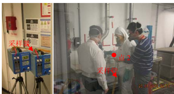
图 3 调漆间现场试验图
