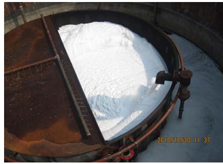
图 8 正戊烷灭火试验照片（预燃） 图 9 正戊烷灭火试验照片（灭火后）
