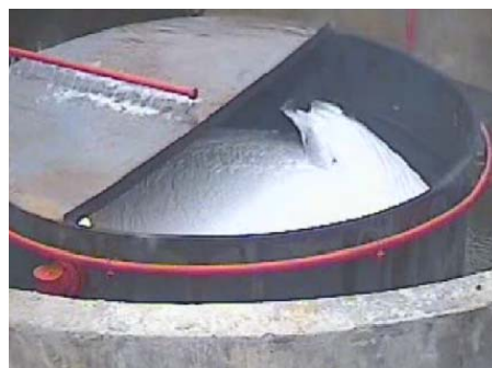
图 7 环氧丙烷灭火试验照片（灭火后）
