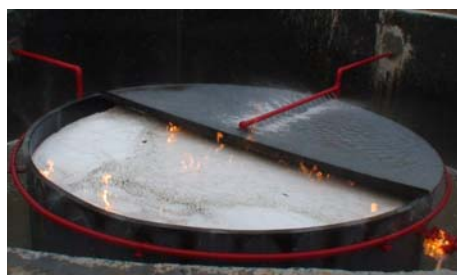
图 3 环氧丙烷空气泡沫试验照片
