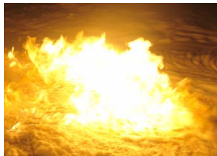
图 2 空气泡沫燃烧现象
