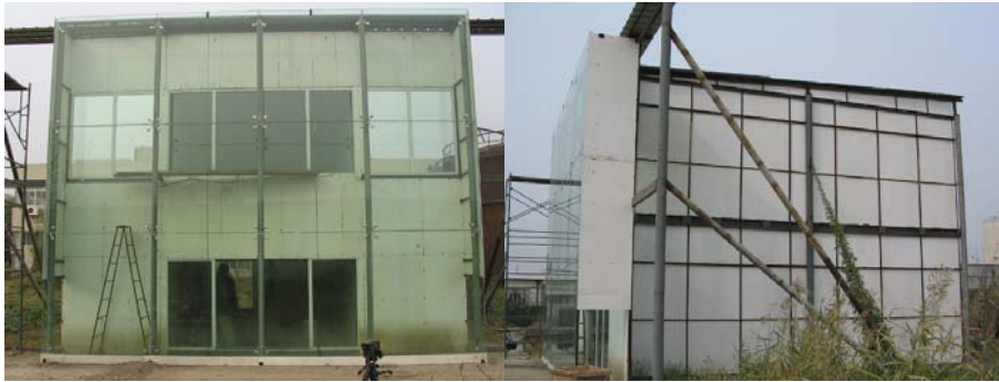
图 4 实验幕墙模型正、侧面照片
