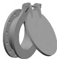
图 1 上翻式拍门三维模型
