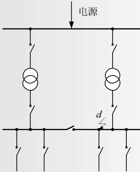
若接于低压侧母线上的线路为馈电线路，则低压母线上的故障就可以由相应变压器的过电流保护使变压器断路器跳闸予以切除
