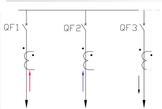
正常运行或外部短路故障时，流入各支路电流相量和为零，即支路电流中瞬时值有正、有负。
