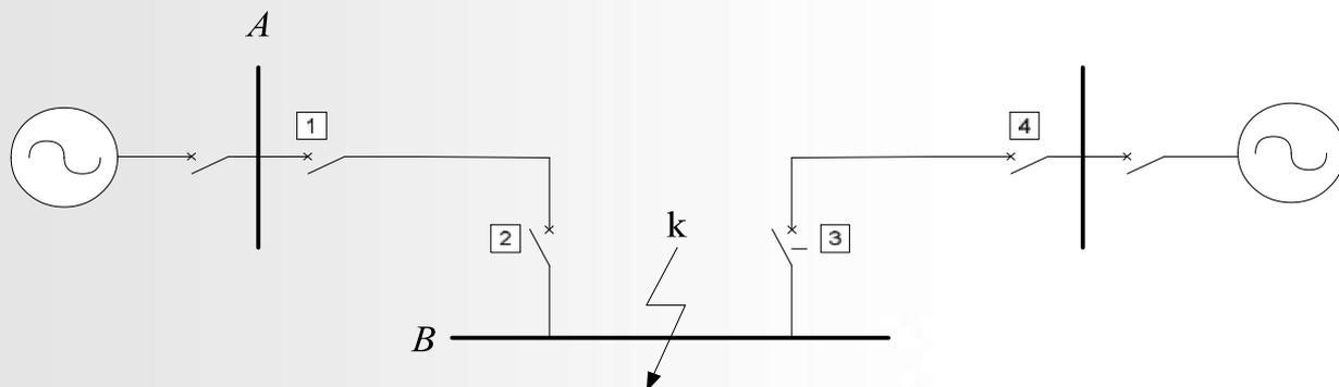
当变电所B母线上d点短路时，则可以由保护1和4的第II段动作予以切除
