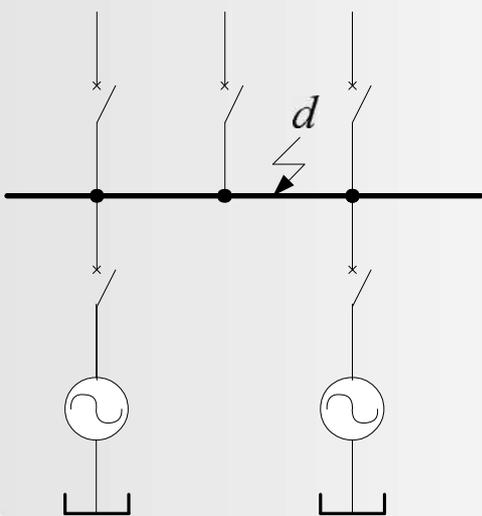
若接于母线的线路对侧没有电源，此时母线上的故障就可以利用发电机的过电流保护使发电机的断路器跳闸予以切除
