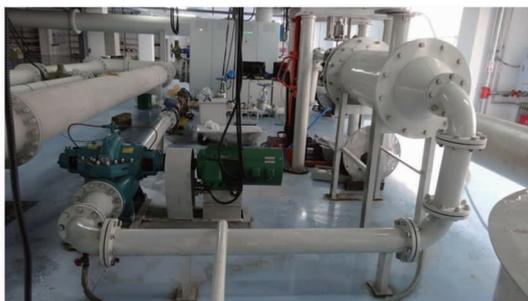
图1 混流泵试验装置
