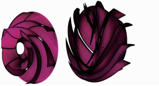
图5 叶轮与导叶区的计算网格
