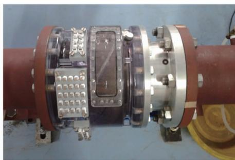
图2 混流泵试验图
