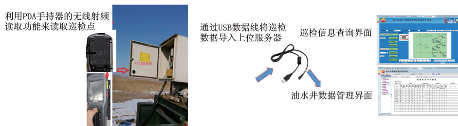
图2 油水井数据采集巡检系统操作示意图
