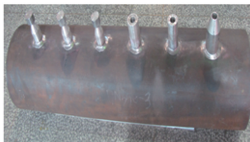
图5 支管台开孔集中处预制形式
