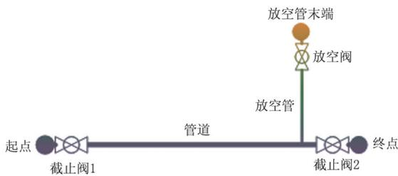
图1 CO<sub>2</sub>管道放空模型
