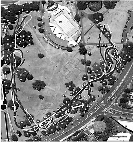
图 5 重载卫星图的 SLAM 与 GPS 定位结果 Fig. 5 SLAM and GPS positioning results with environment satellite image
