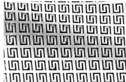
图 4 显微镜下的转换膜结构
