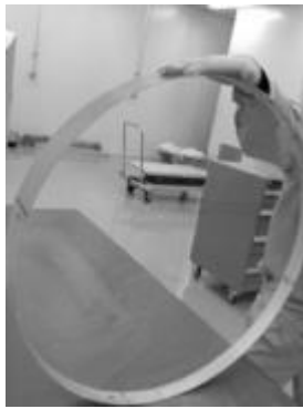
图 8 导光板抛光完成后的照片
