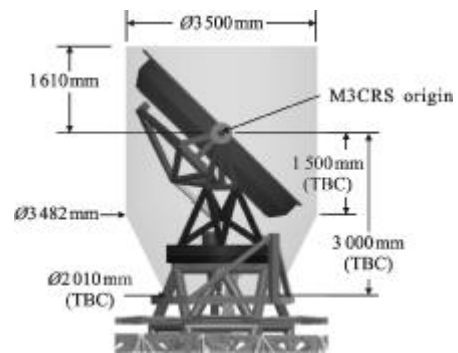
图 2 三镜系统的设计空间示意图
