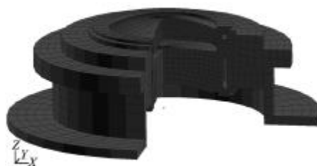
图 9 透镜结构有限元模型
