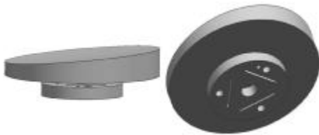
图 4 反射镜单点安装
