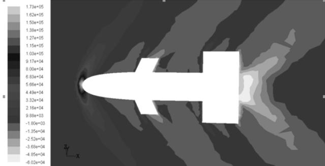
图 6  $\alpha=0^\circ$   $Ma=0.8$  流场压力分布曲线截面图
