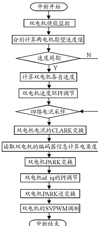
图 5 中断服务程序流程图
