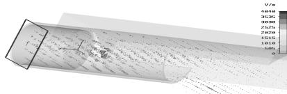
图 4 VLASOV 准光模式变换器辐射图
