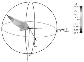
图 7 VLASOV 准光变换器三维方向图
