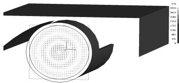
图 3 VLASOV 准光模式变换器端口输入模式图
