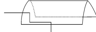
图 1 单反射面 VLASOV 准光变换器示意图
