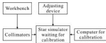
图 2 标定系统工作原理图
