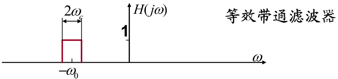
相当于从  $X(j\omega)$  中直接用一个带通滤波器滤出的频谱。表明整个系统相当于一个中心频率为  $\omega_0$  的带通滤波器，改变  $\omega_0$  即可实现中心频率可变。
