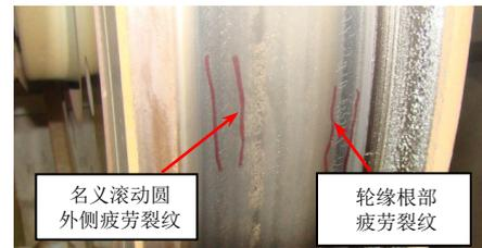
图15 车轮踏面疲劳裂纹
