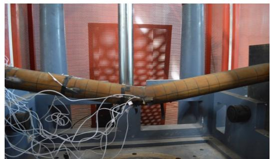
图 10 遭受撞击后的圆形管柱
