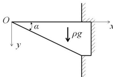
3. 试用虚位移原理求如图所示梁的挠度曲线, 并求出当  $a = l/2$  处的挠度值, 设
