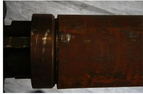
图6 S2的外套管鼓胀现象
