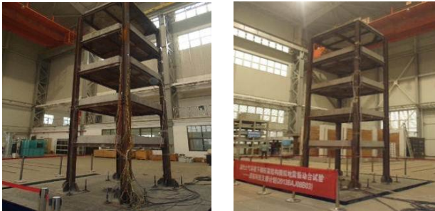
(a) 未锈蚀结构 (b) 锈蚀结构
