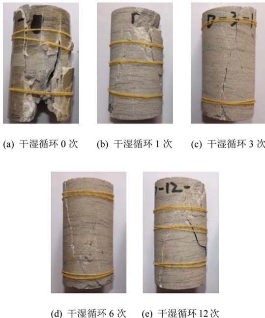
图 11 不同干湿循环次数下粉砂岩破坏形态
