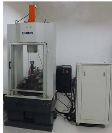
图1 ZYSS2000 型岩石高温高压蠕变仪
