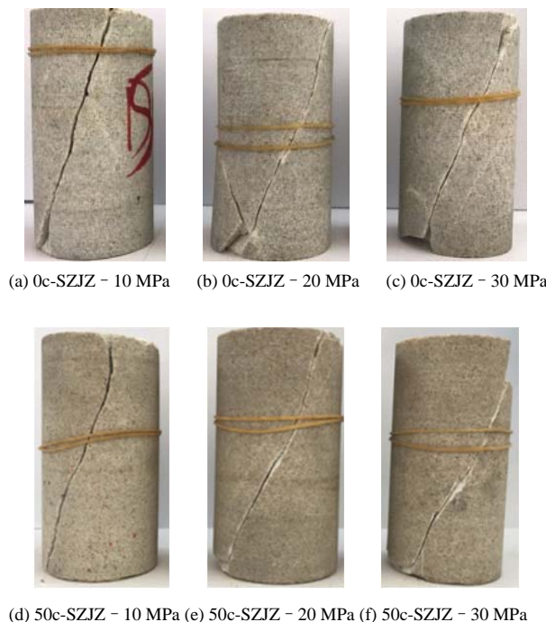
图 8 部分岩石试样三轴压缩破坏照片
