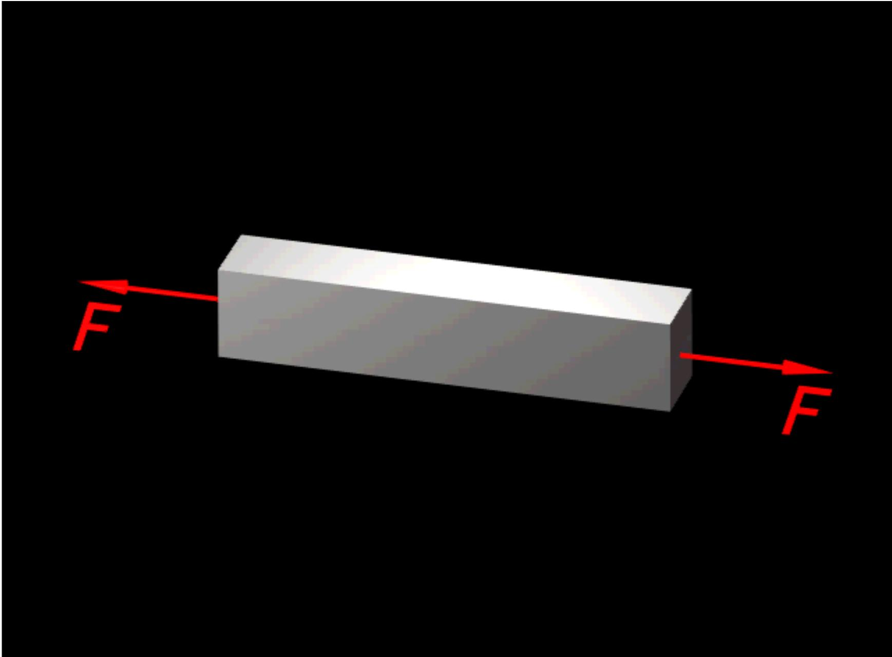
回忆铸铁破坏时破坏面与横截面成 $45^\circ$ 角的原因为何？
