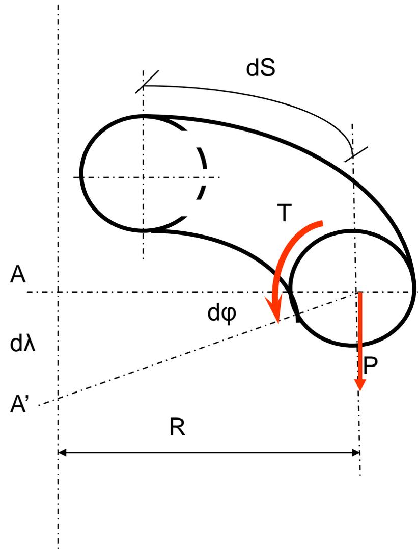
**[例]** 圆柱形密圈螺旋弹簧的平均直径为： $D=125\text{mm}$ ，簧丝直径为： $d=18\text{mm}$ ，受拉力  $P=500\text{N}$  的作用，试求最大剪应力的近似值和精确值；若  $G=82\text{GPa}$ ，欲使弹簧变形等于 $6\text{mm}$ ，问：弹簧至少应有几圈？
